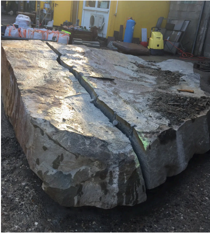
Rotsblok in het terrein gecontroleerd gespleten
