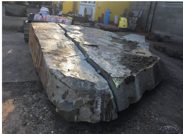
Rotsblok trillingsvrij gespleten – zonder lawaai, zonder springstof.
