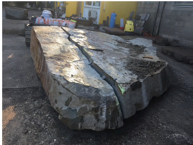
Bloque partido sin vibraciones – sin ruido, sin explosivos.
