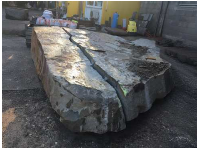
Bloc erratique fendu sans vibrations – sans bruit, sans explosif.
