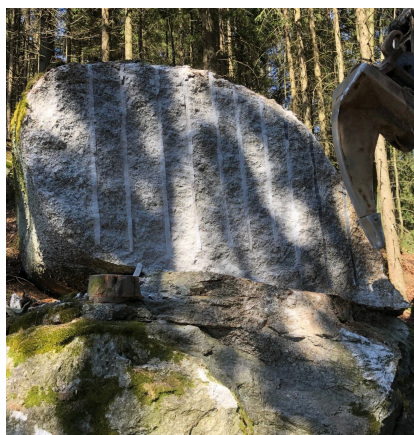
Bloc erratique en forêt fendu sans bruit en dalles
