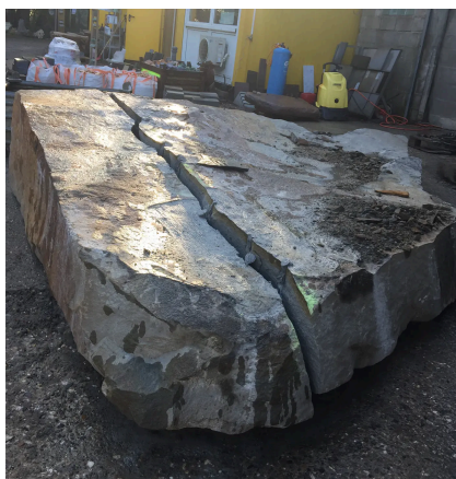
Bloc erratique en terrain ouvert fendu de manière contrôlée
