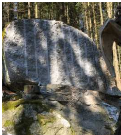
Безшумно разрязване на голям скален къс на плочи в гора
