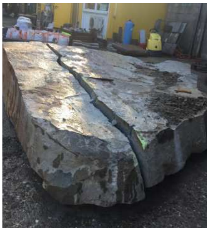
Стенски блок на терену контролисано расцепљен
