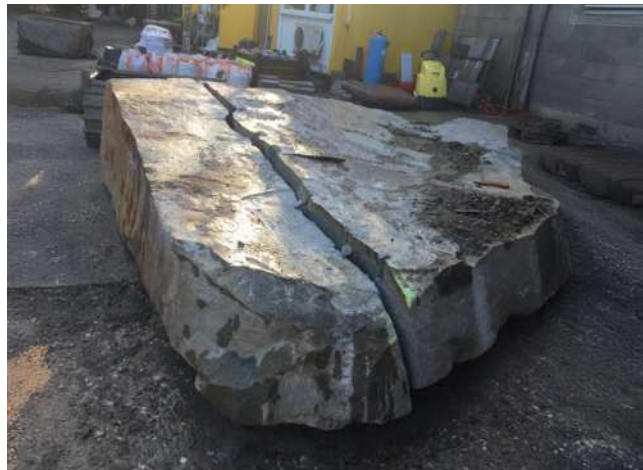
Стенски блок расцепљен без вибрација – без буке, без минирања.
