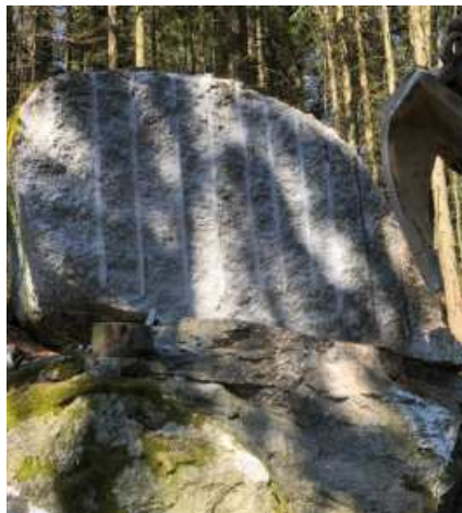
Siirtolohkare metsässä meluttomasti levyiksi leikattuna
