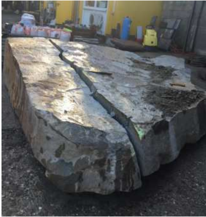
Felsblock im Gelände kontrolliert gespalten
