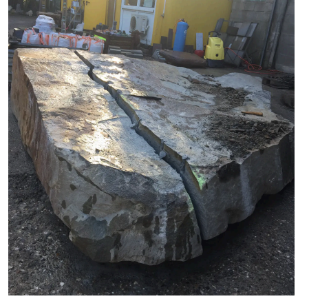
صخرة في أرض مفتوحة تم شققها بشكل مُتحكَّم فيه
