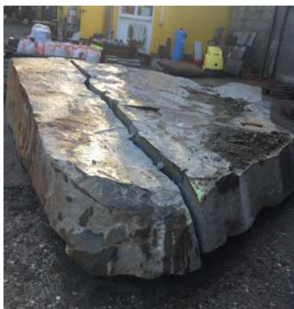
Masso in terreno aperto spaccato in modo controllato
