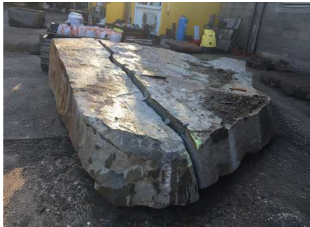
Stenski blok rascepljen bez vibracija – bez buke, bez miniranja.
