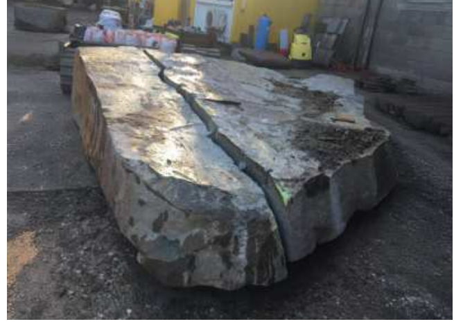
Kaya bloğu sarsıntısız kırıldı – gürültüsüz, patlatmasız.
